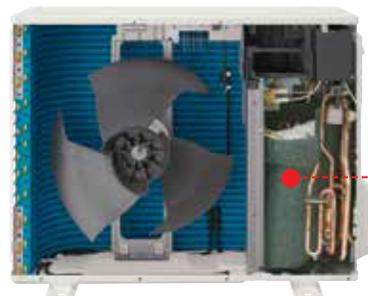
Les composants disposés de manière ordonnée sont la preuve d'une finition de haute précision et soignée. Le compresseur, qui est le cœur du climatiseur, est enveloppé d'un isolant pour assurer l'insonorisation et réduire la condensation.
