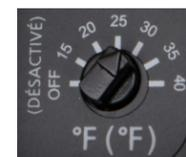
**Réglage de la température** – Le réglage personnalisé de température basse arrête le ventilateur lorsque l'air entrant est trop froid. Le ventilateur s'arrête (ou ne se met pas en marche) lorsque la température extérieure est inférieure à la valeur du réglage (de -9 °C (15 °F) à 4 °C (40 °F)). Le ventilateur arrête de fonctionner lorsque la température de l'air entrant est supérieure à 35 °C (95 °F).
