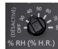
**Réglage de l'humidité** – Distribution d'air frais personnalisée basée sur les conditions d'humidité de l'air entrant. Le ventilateur s'arrête automatiquement (ou ne se met pas en marche) lorsque l'humidité relative extérieure est supérieure au réglage sur le sélecteur d'humidité (HR de 30 % à 80 %).
